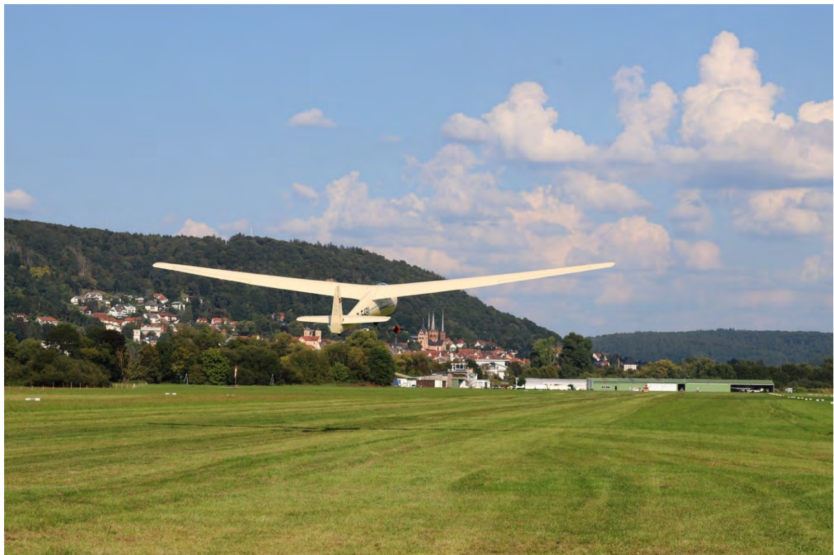
Eine Motorwinde zieht einen Segelflug-Oldtimer auf Höhen von 300-400 Metern über die Stadt.
